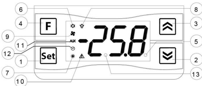
**1 – Tecla SET** : Pulsando y soltando rápidamente se accede al cambio de Set Point.
