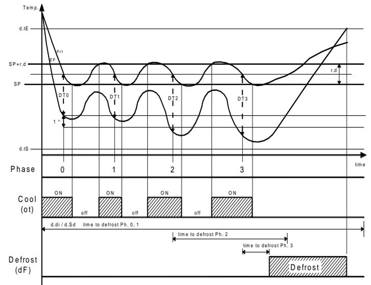
Ejemplo de funcionamiento "dynamic defrost intervals system" con reducción "d.dd" = 30 % y final de descarche por temperatura.
