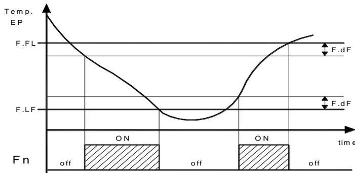
Es posible establecer la desactivación del ventilador cuando la temperatura medida por la sonda del evaporador es superior al valor programado en el parámetro "F.FL" (temperatura demasiado alta) o también cuando es inferior al valor programado en el parámetro "F.LF" (temperatura muy baja).
