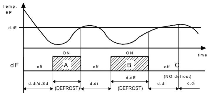
*Ejemplo de fin de descarche: El descarche indica como A termina por llegar a la temperatura "d.tE", la parte B termina al final de "d.dE" en cuanto a la tempera "d.tE" se alcanza, el descarche C no actúa cuando la temperatura es superior a "d.tE".*
