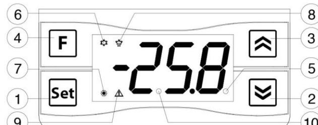
**1 - TECLA "SET":** Pulsando y soltando, programación del valor de regulación (Set Point). Manteniendo durante 5 segundos, entrada al menú configuración.
