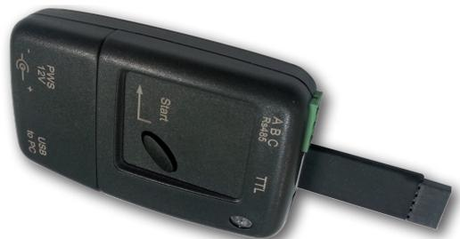
Le KEY USB est utilisé pour la programmation en série des contrôleurs qui doivent avoir les mêmes paramètres, ou pour enregistrer une copie de la programmation du contrôleur et pour pouvoir la transférer rapidement.
