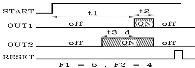
En programmant F2=0 la sortie OUT 2 est inactive.
