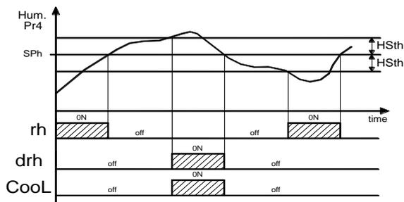
= HC - La deshumidificación viene realizada mediante la activación contemporánea de la salida configurada como Frio e HEAt.
