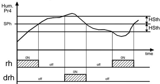
= drhC - La deshumidificación viene realizada mediante la activación contemporánea de la salida configurada como drh e Frio.
