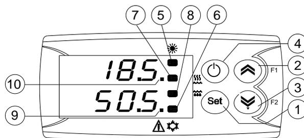
**1 - Tecla SET:** Uso para la PROGRAMACIÓN del Set point y para la programación de parámetros de funcionamiento. En modalidad de programación puede ser utilizado conjuntamente con la tecla SUBIR para modificar el nivel de programación de los parámetros.
