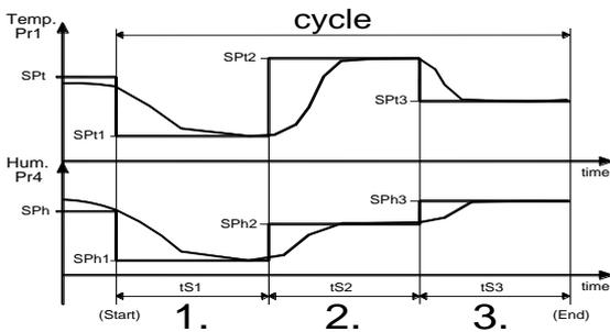
A veces se desea utilizar un número inferior de fases y es suficiente programar el tiempo de la fase como = OFF. Ejemplo si se desea realizar el ciclo con solo dos fases programar "tS3" = OFF.
