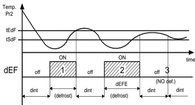
**Ejemplo:** El descarche 1 termina por final de temperatura **"tEdF"**, el descarche 2 termina sobre pasar el tiempo **"dEFE"** en cuanto el descarche tres que debería iniciar no viene realizado por que la temperatura es Superior a la temperatura del par **"tSdF"**. (temperatura habilitación descarche)
