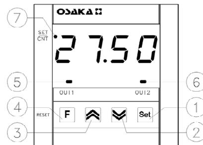
**1 – Tecla set** : Utilizada para la programación de los set point y los parámetros de funcionamiento.
